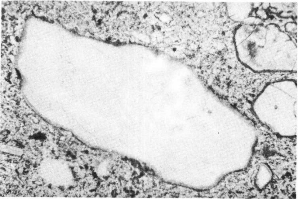
Рис. 26. Фрагмент санидинового мегакристалла с реакционной каймой пироксеновых микролитов. Николи +, \times 60
